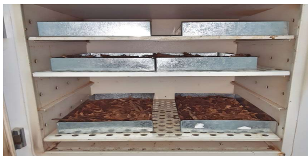
Figura 2 – Secagem dos cavacos de eucalipto em estufa elétrica (60°).
