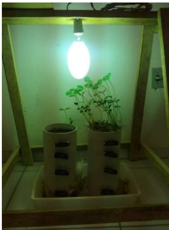
Figura 1. Experimento didático sobre condutividade térmica em solos sob diferentes sistemas de cultivo.
