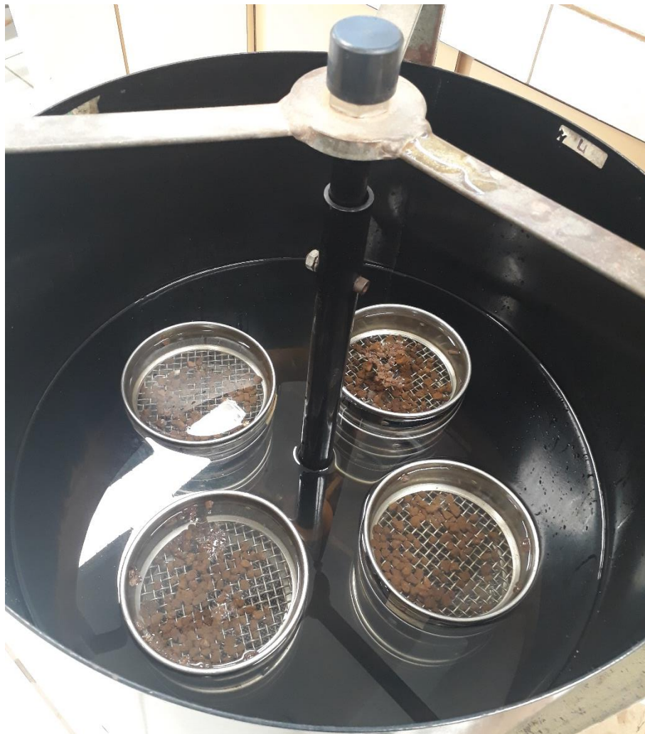
Figura 8 - Amostras de solo submetidas à determinação da estabilidade de agregados no aparelho de oscilação vertical
