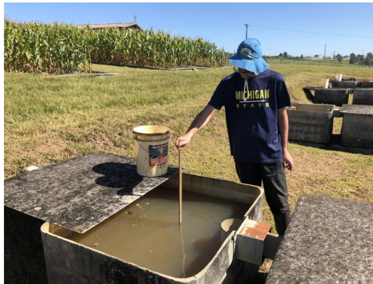
Figura 8 - Procedimento de leitura da altura da enxurrada no tanque de sedimentação, com auxílio da régua graduada.
