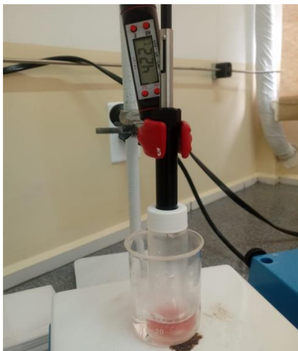
Figura 10- Sistema de isolamento dos compostos voláteis extraído da uva e vinho, utilizando-se a técnica HS-SPME
