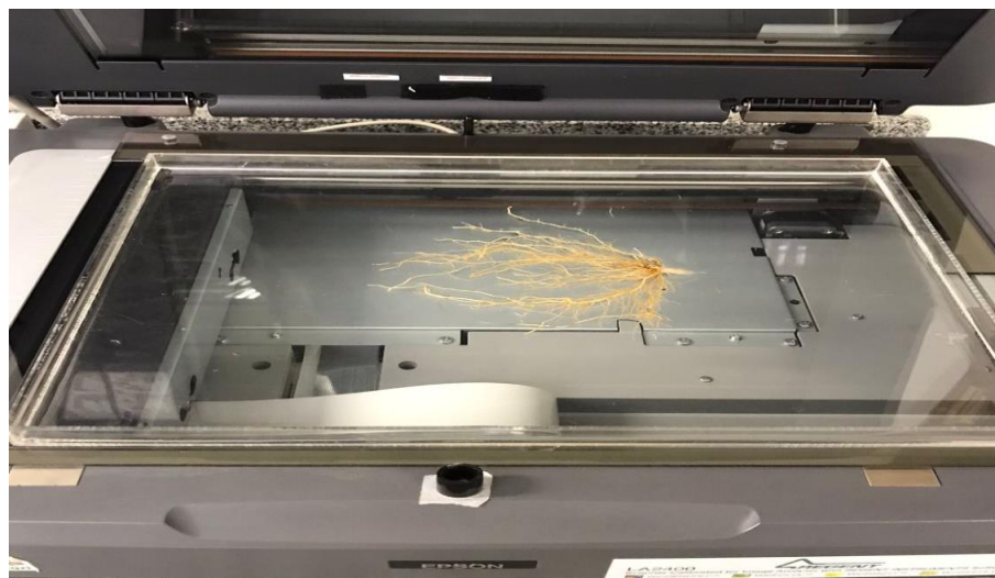
Figura 3 - Escaneamento das raízes de feijão na Scanner Epson® modelo LA2400.
