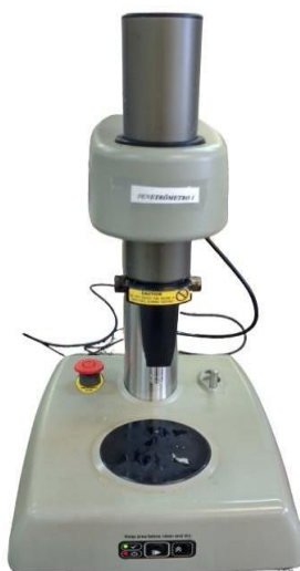
Figura 6 - Penetrômetro automatizado Guss utilizado para medição da firmeza de polpa
