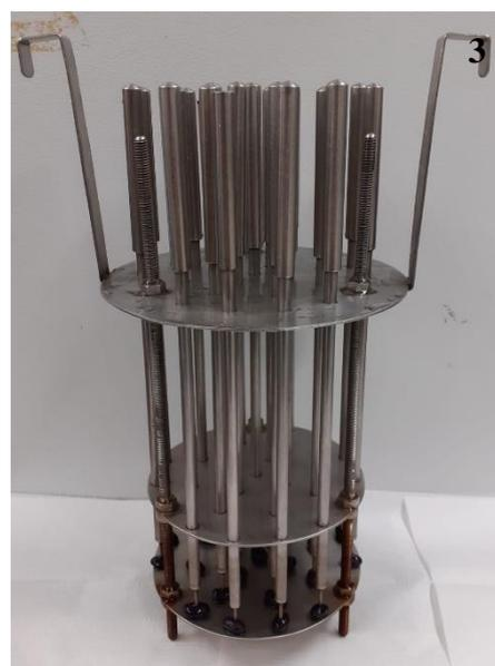
1: processo de cozimento utilizando o cozedor Mattson; 2: grãos das progênies em processo de hidratação (anteriormente ao teste de cocção); 3: cozedor Mattson
