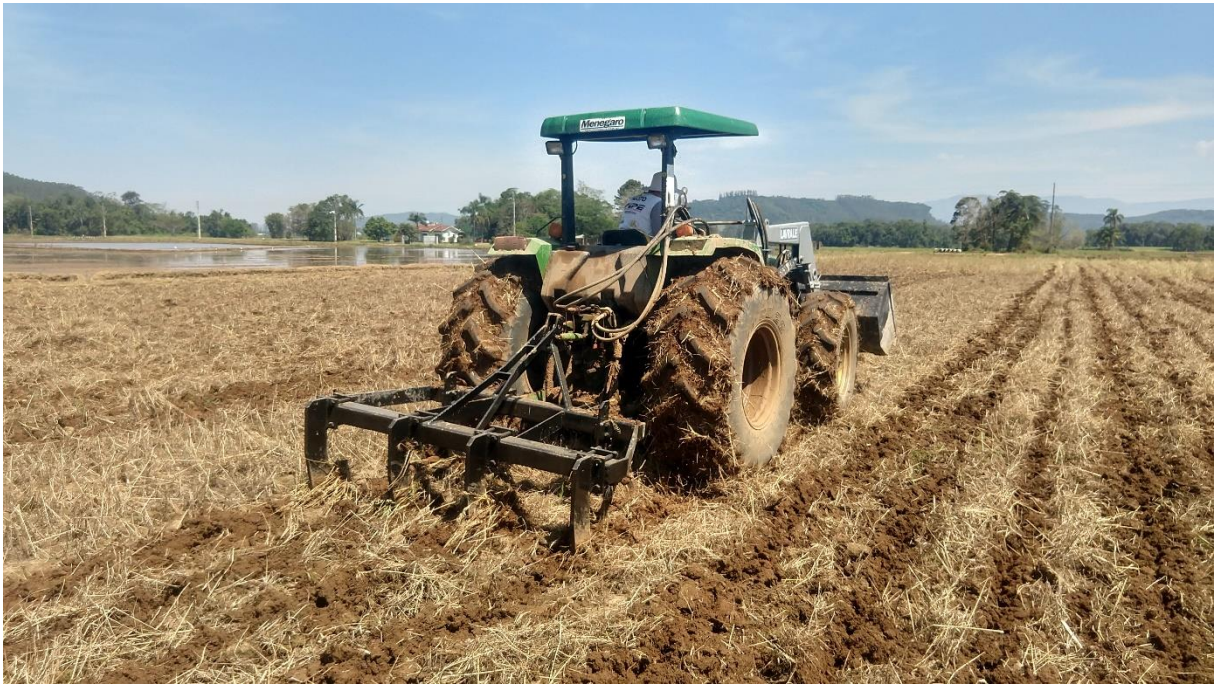
Figura 4 – Descompactação área de várzea utilizando subsolador na pré-semeadura da soja em Turvo/SC.
