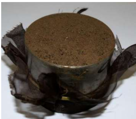
Imagem 10 – Amostra de estrutura preservada do Nitossolo Bruno em cilindro volumétrico com um tecido permeável preso à base da amostra com borracha elástica.
