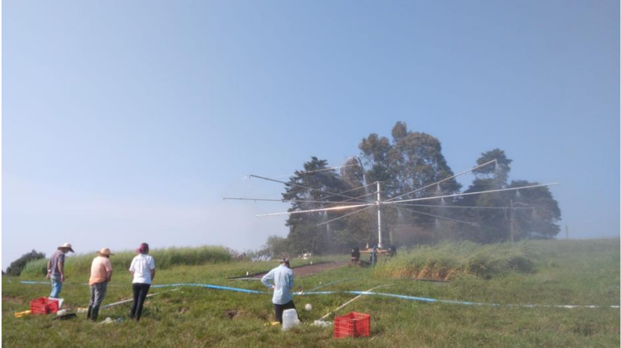
Figura 12: Simulador de chuva com braços rotativos tipo empuxo realizando teste de chuva em duas parcelas simultaneamente em um Cambissolo Húmico em Lages SC.
