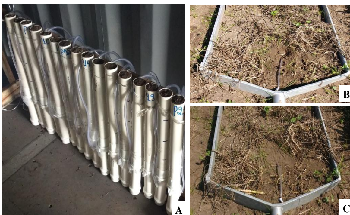
Figura 6 - Etapas da instalação dos lisímetros no experimento: montagem e preenchimento das camadas de solo (0,00 - 0,40 m) no interior dos lisímetros (A) e instalação dos lisímetros centralizados na parte inferior das parcelas (B e C).
