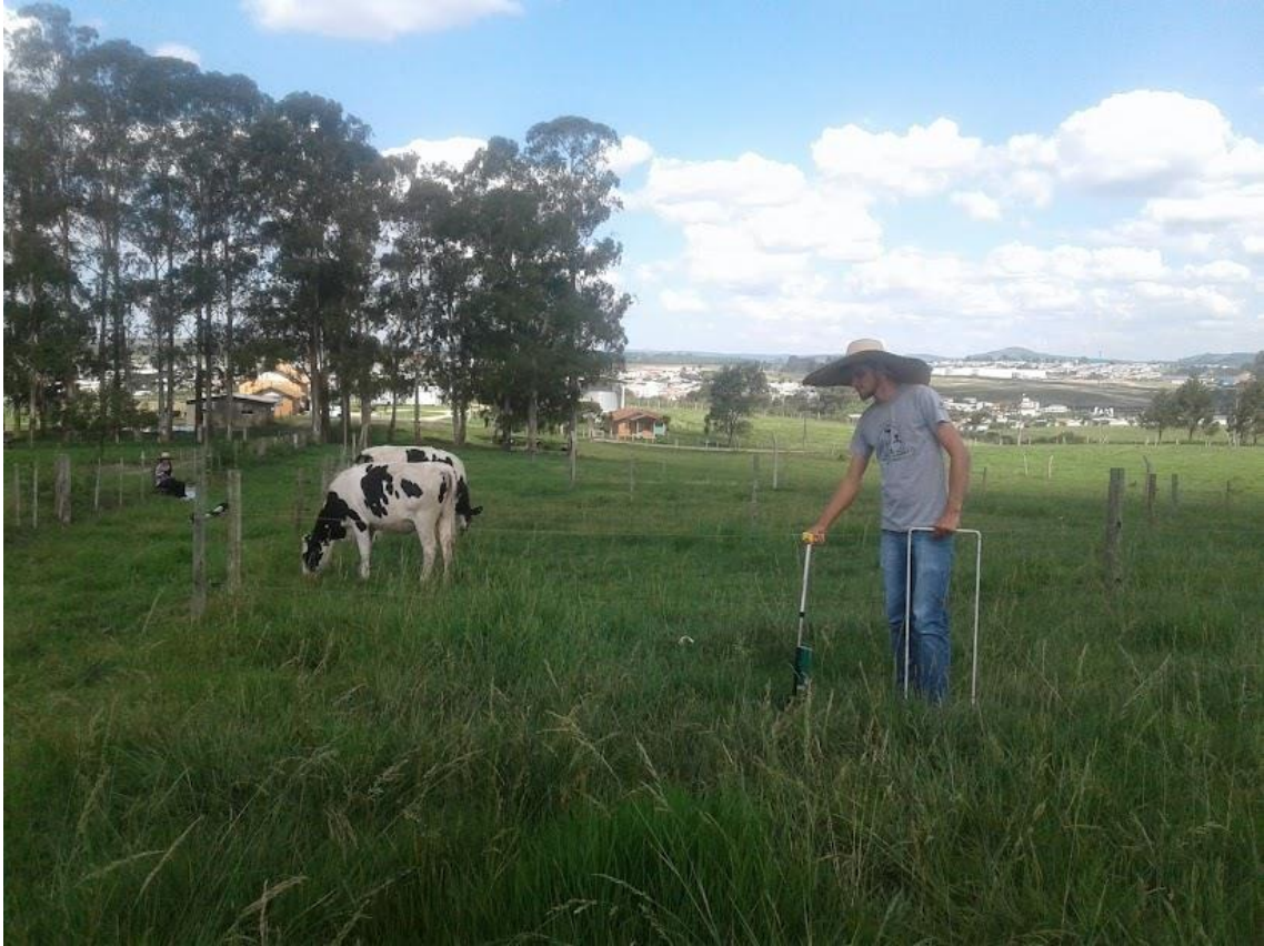
Figura 10 - Mensuração da massa de forragem com uso de Rising Plate Meter , em pasto formado por L. arundinaceum e C. clandestinus , no final da primavera do ano de 2018.
