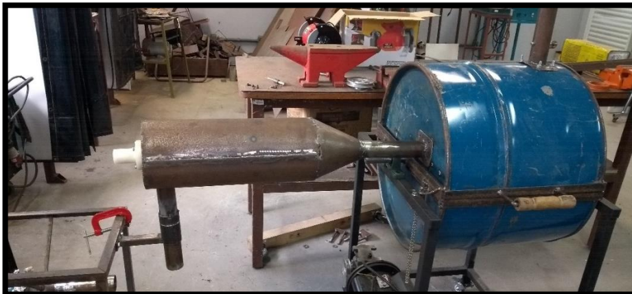
Pré-montagem domódulo queimador com câmara de torrefação e ventilação
