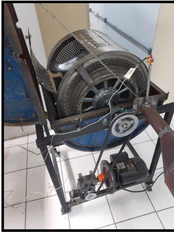
Câmara de torrefação paramentado com termopar e motoredutor.
