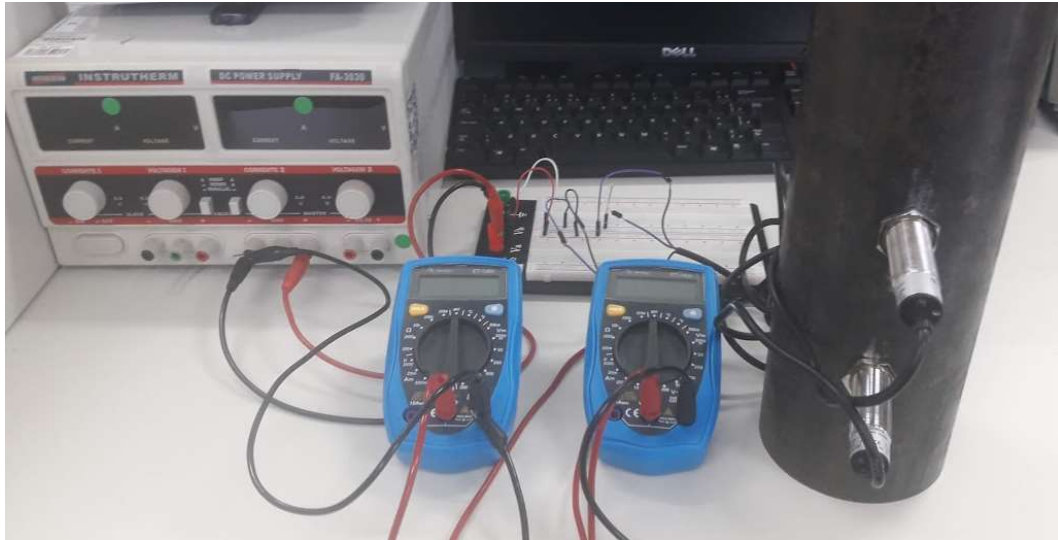
Figura 23: Sistema de medição para teste dos sensores capacitivos
