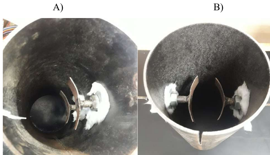
Figura 32: Possíveis arranjos para instalação dos elementos sensores
