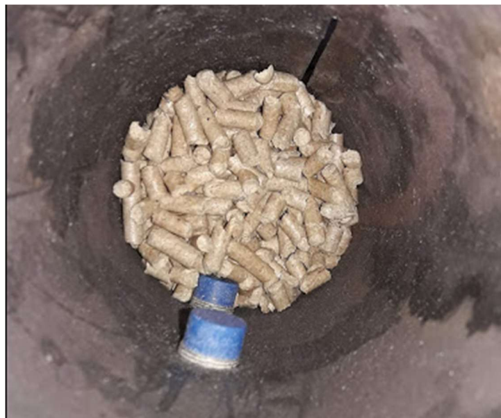
Figura 24: Teste dos sensores capacitivos em temperatura ambiente
