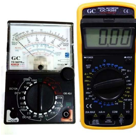
Figura 8: Instrumentos de medidas analógicos e digitais
