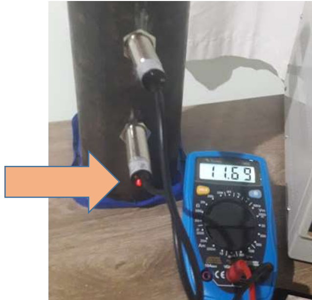
Figura 25: Resposta do sensor capacitivo
