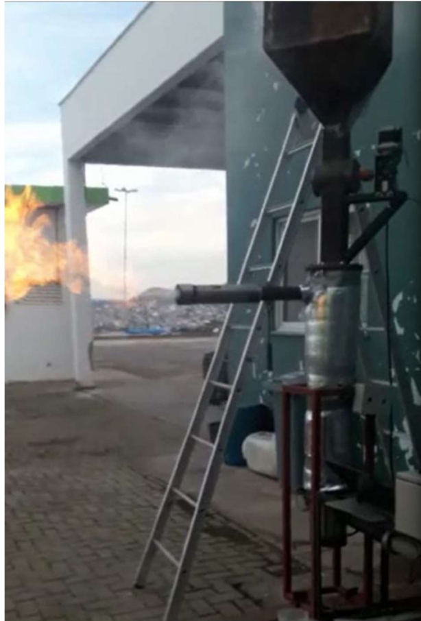
Figura 20: Protótipo de gaseificador de biomassa em teste
