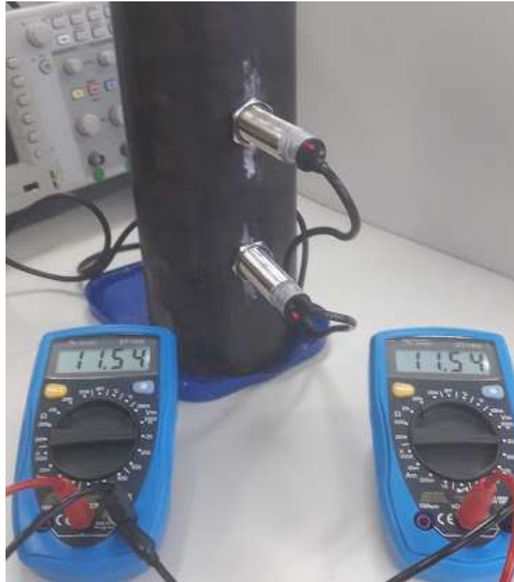
Figura 26: Teste com dois sensores capacitivos
