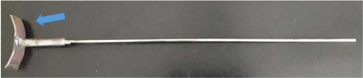
Figura 31: Elemento sensor capacitivo
