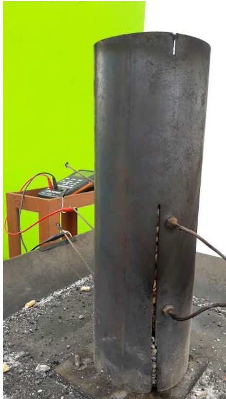
Figura 43: Biomassa posicionada em frente as duas placas dos elementos sensores
