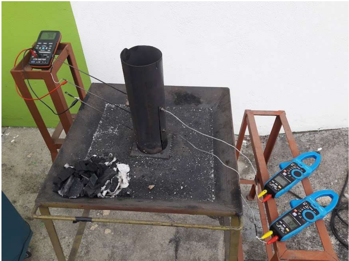
Figura 41: Teste dos elementos sensores capacitivos em alta temperatura
