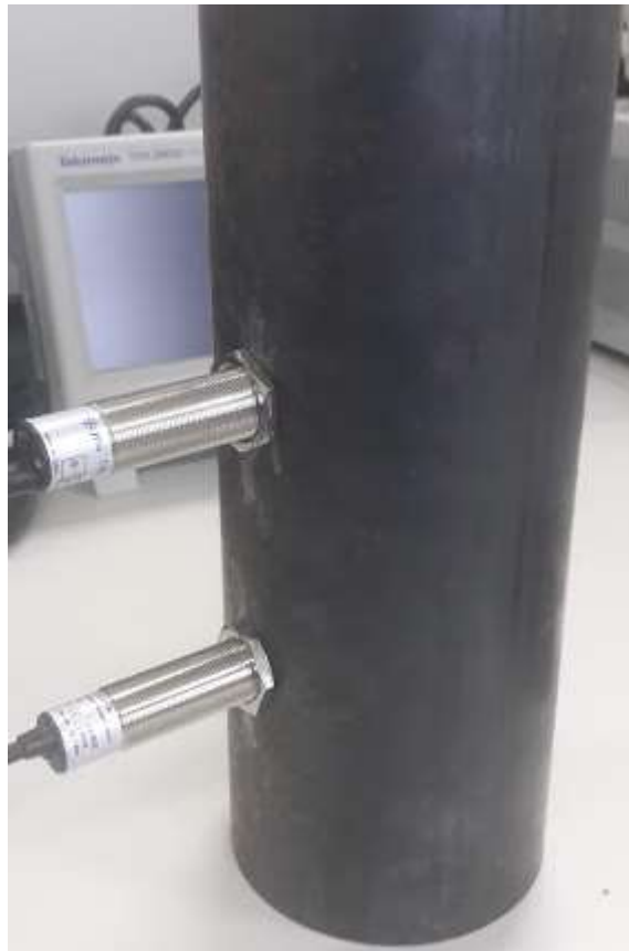
Figura 21: Modelo de reator de aço com sensores instalados
