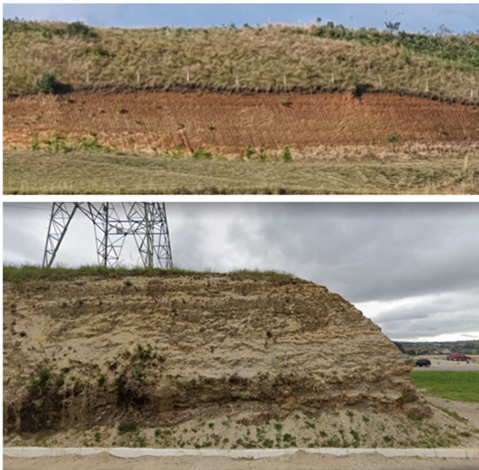
Figura 4 - Cortes no terreno na região de estudo, apresentando características de Cambissolo.
