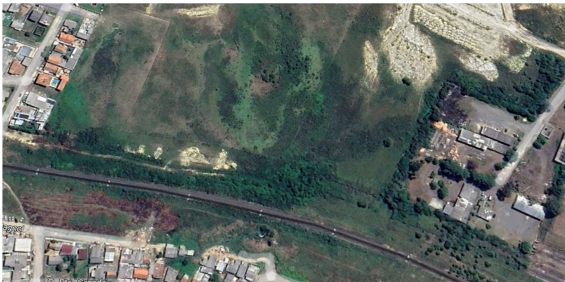
Figura 12 - Linha férrea como restrição à drenagem natural.
