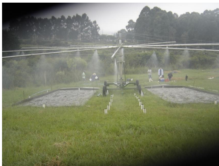
Figura 3. Simulador de chuva tipo empuxo em operação na pesquisa
