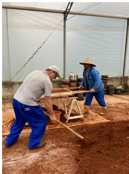
Figura 5 – Solo utilizado no experimento em vaso sendo peneirado
