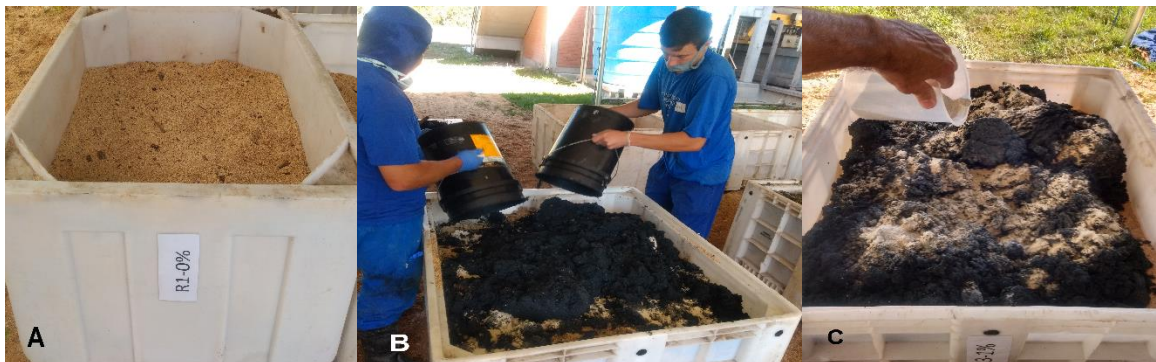
Figura 4 – Preparo dos caixotes com serragem (A), dosagem de lodo (B) e dosagem de bentonita (C)
