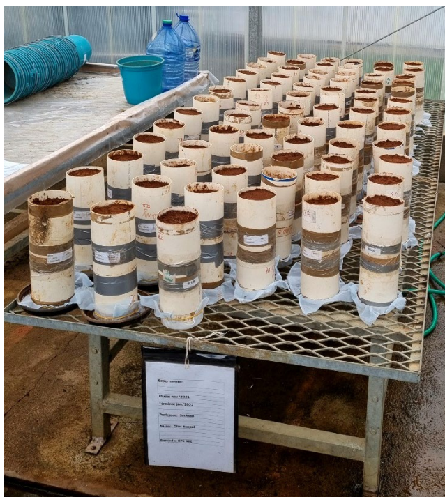
Figura 10 - Vasos montados com três camadas de solo em tubo PVC.
