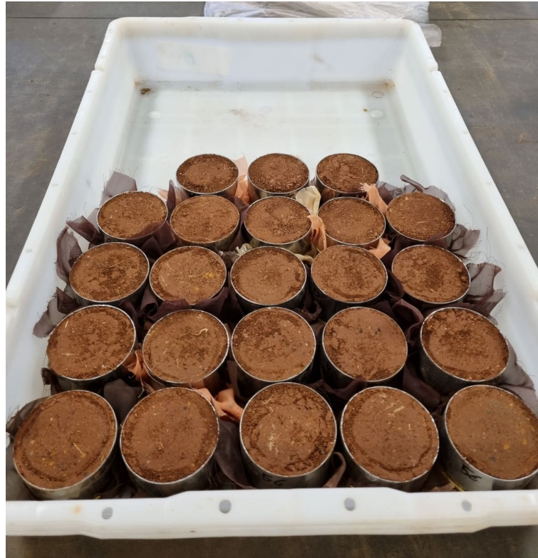
Figura 5 - Anéis volumétricos compactados artificialmente com cinco repetições de cada um dos graus de compactação - 85, 90, 95, 100 e 105% da Dsm .
