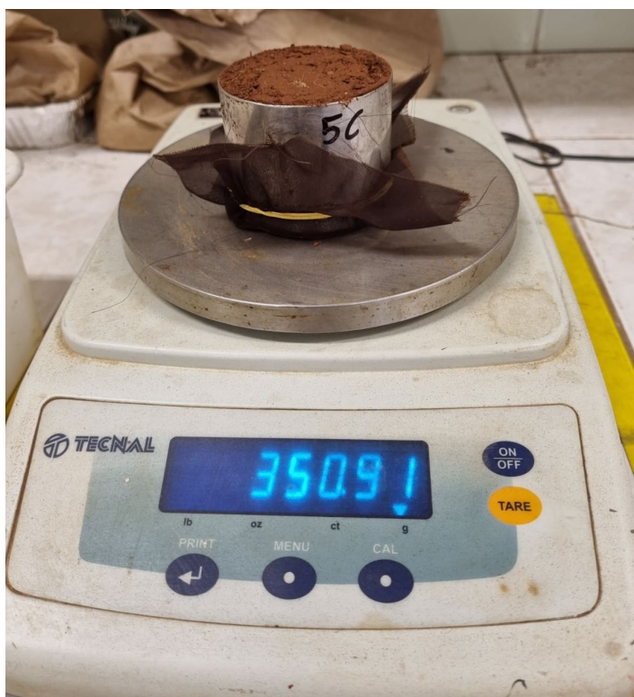
Figura 6 - Pesagem do anel volumétrico, em balança de precisão, após tensão de 100 hPa, em mesa de tensão em areia.
