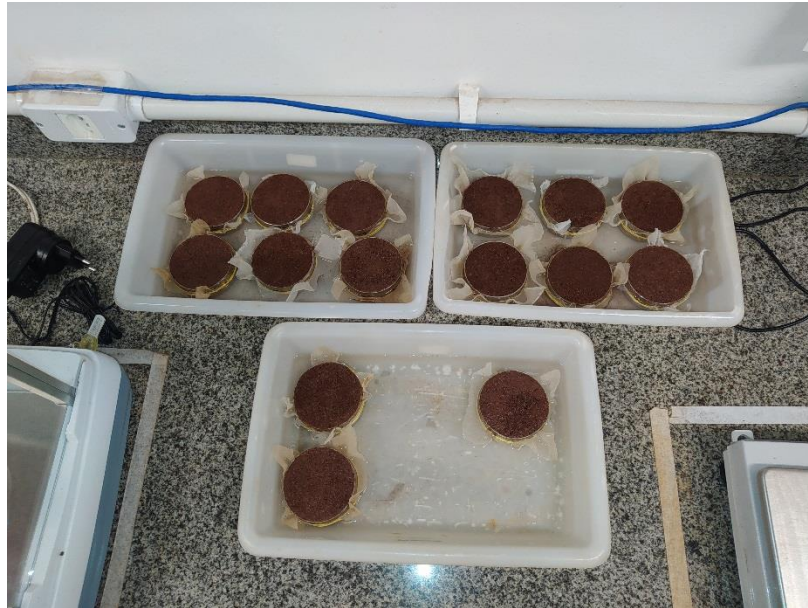
Figura 10 – Amostras depois do “toalete” sendo saturadas por capilaridade
