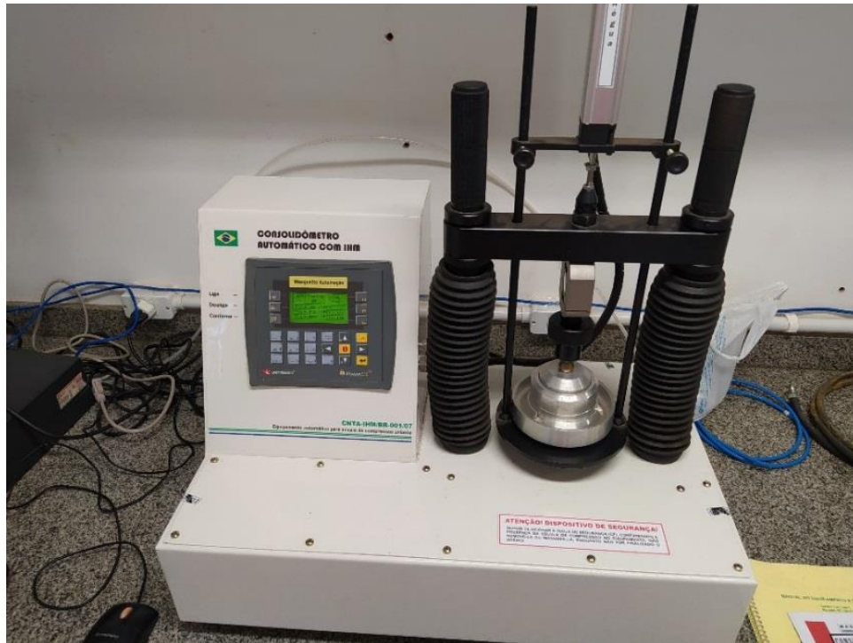
Figura 11 - Consolidômetro automatizado com IHM incorporada
