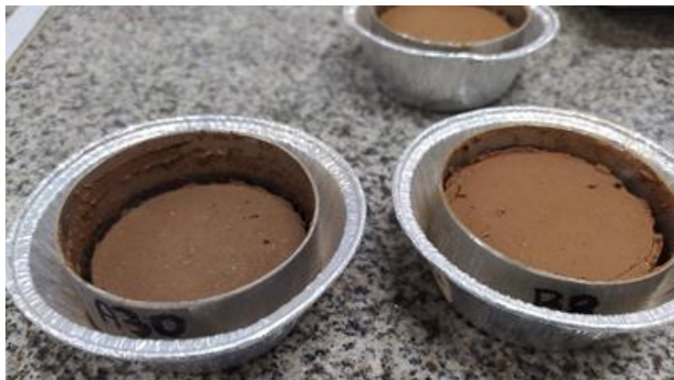
Figura 18 – Diferença de retração do LBVAC HA e HB depois das amostras serem compactadas e secas em estufa
