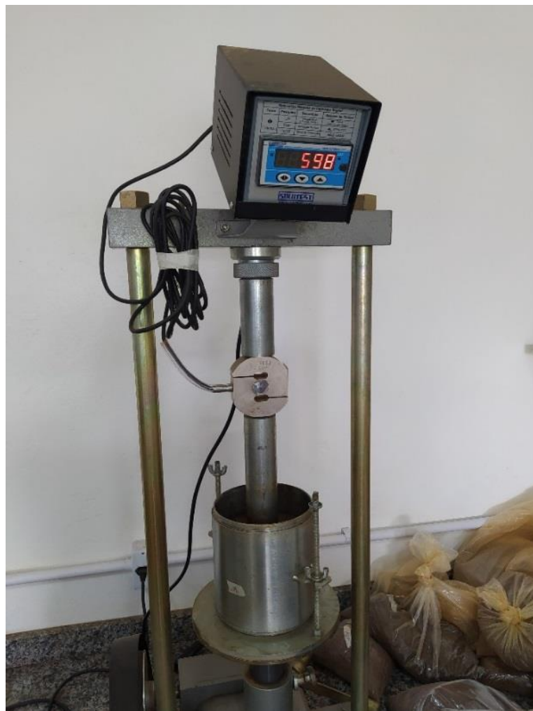
Figura 13 – Corpo de prova compactado sendo rompido na prensa CBR
