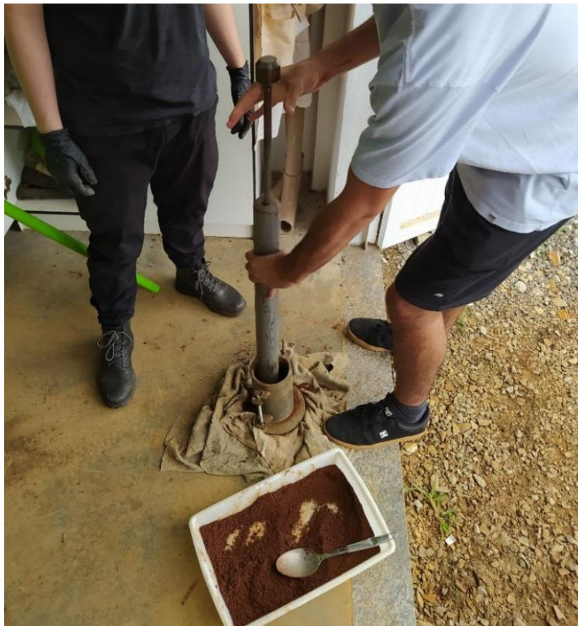
Figura 12 – Execução do ensaio de compactação
