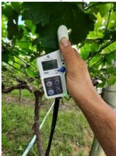
Figura 37 - Mensuração do índice de clorofila (SPAD) em folha do terço médio do sarmento.
