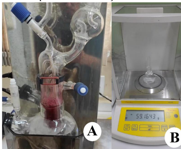
Figura 45 - A) Destilação da amostra de vinho; B) Aferição da massa da amostra no picnômetro em balança analítica.
