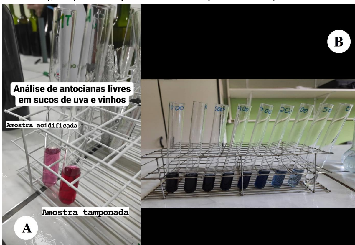
Figura 46 - A) Tubos de ensaio com amostra acidificada e amostra tamponada para análise de antocianinas livres; B) Tubos de ensaio contendo as diferentes concentrações do padrão de ácido gálico para construção da curva de calibração da análise de polifenóis totais.
