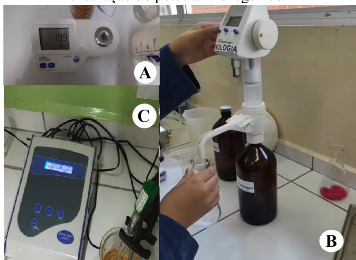
Figura 43 - A) Mensuração de sólidos solúveis; B) Titulação das amostras de mosto; C) Mensuração do potencial hidrogênico.
