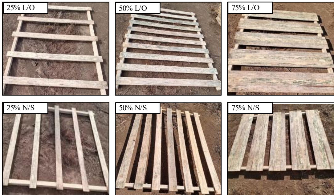
Figura 2 — Estruturas de madeira para simulação de sombreamento na cultura da aveia branca nas safras 2020 e 2021
