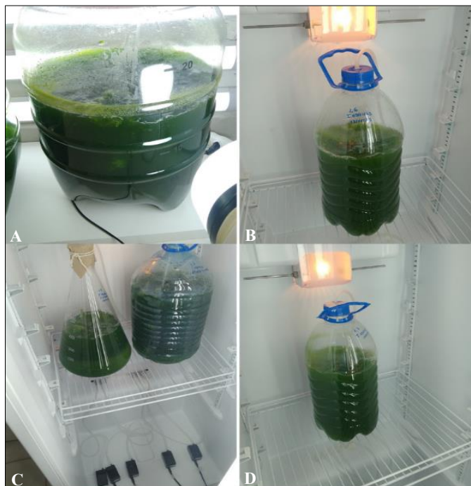
Figura 04 - Aclimação para o experimento. (a) Aclimação no efluente com volume de 15L na sala de microbiologia; (b) Aclimação da temperatura de 10 °C na incubadora, (c) Aclimação da temperatura de 20 °C na incubadora; (d) Aclimação da temperatura de 30 °C na incubadora.
