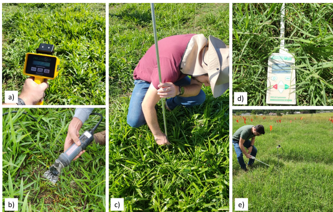
Figura 4 - Detalhe do aparelho Spectrum® FieldScout CM 1000 NDVI Meter (a), corte do dossel com tosquiadeira adaptada (b), medição da altura de dossel utilizando sward stick (c), detalhe da medição da interceptação de radiação abaixo do dossel (d) e acima do dossel (e).
