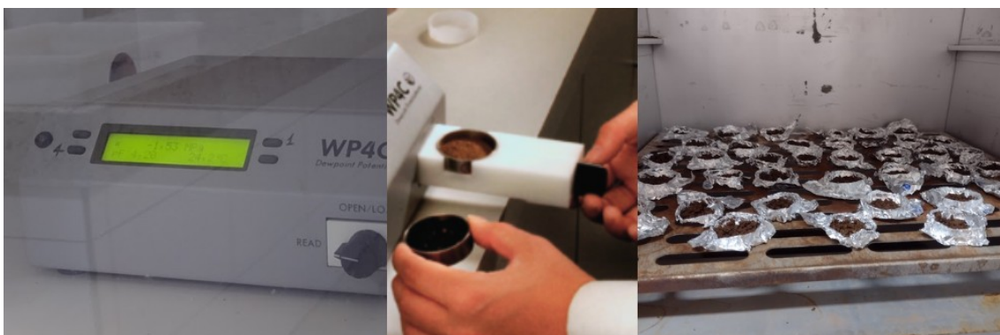
Figura 7 – Psicrômetro WP4C utilizado para obter a pressão no ponto de orvalho para posterior identificação dos valores de umidade e pressão a 15 bar
