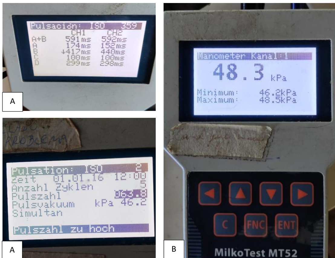
Figura 2 - Mensuração das fases do ciclo de pulsação e pulsações por minuto (A) e o nível de vácuo no sistema (B) com o dispositivo MilkoTest MT52, BEPRO®.
