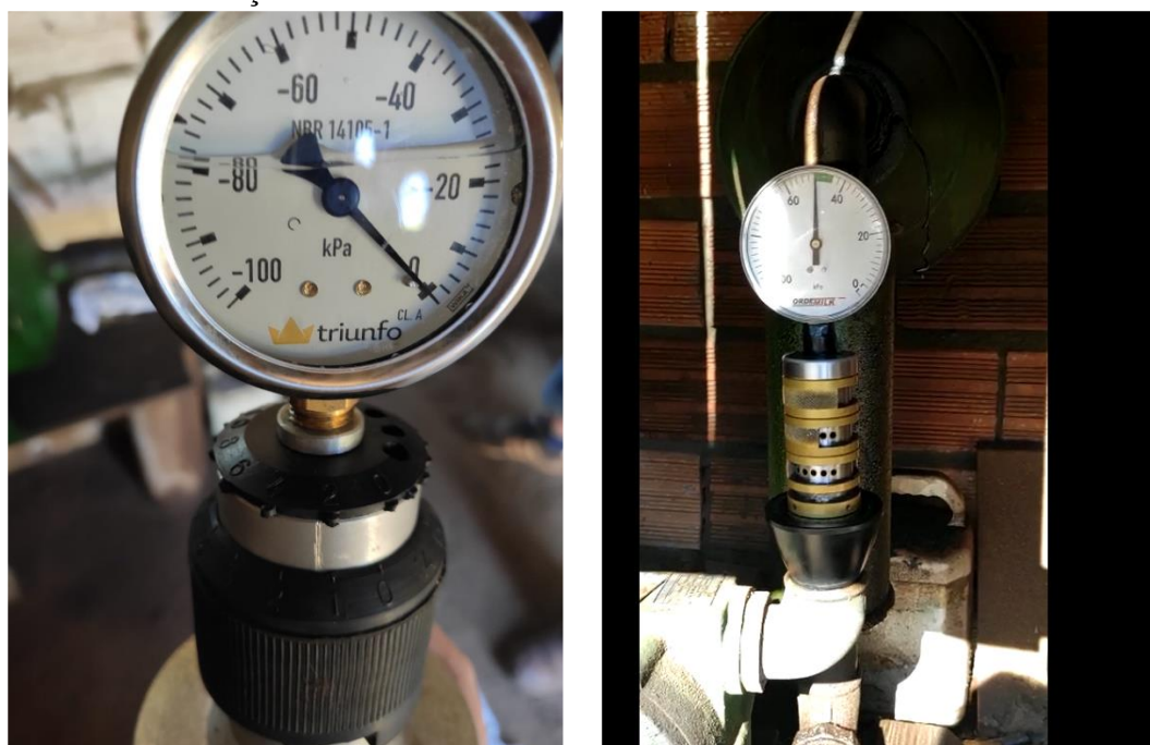
Figura 4 - Vazão da bomba de vácuo verificada com caudalímetro. A esquerda o caudalímetro encontra-se inativo (0 kPa) e a direita o caudalímetro encontra-se acoplado ao início da tubulação da bomba de vácuo marcando 50 kPa.
