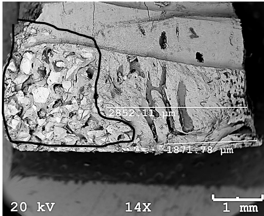
Figura 58 - Fotomicrografia de MEV de osso de ovelha aos 03 meses com o bifásico HA/TCP- \beta 30/70. Observar a porção do osso cortical onde o biomaterial foi absorvido e substituído por osso novo (linhas brancas). O restante da região cortical que ainda apresentou biomaterial remanescente esta representada pela linha preta. Notar que o biomaterial está envolto por osso neoformado.
