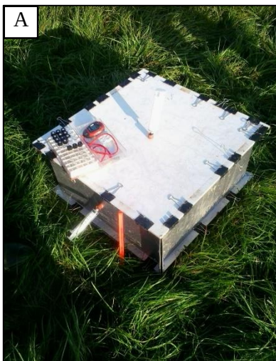
Figura 2 – Fotos do modelo de câmara estática utilizada. Câmara estática fechada (A); Câmara estática sem a cobertura (B).
