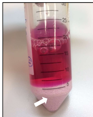
Figura 7 – Grânulos de Biomaterial (seta) Imersos em DMEM com 10% de SFB
