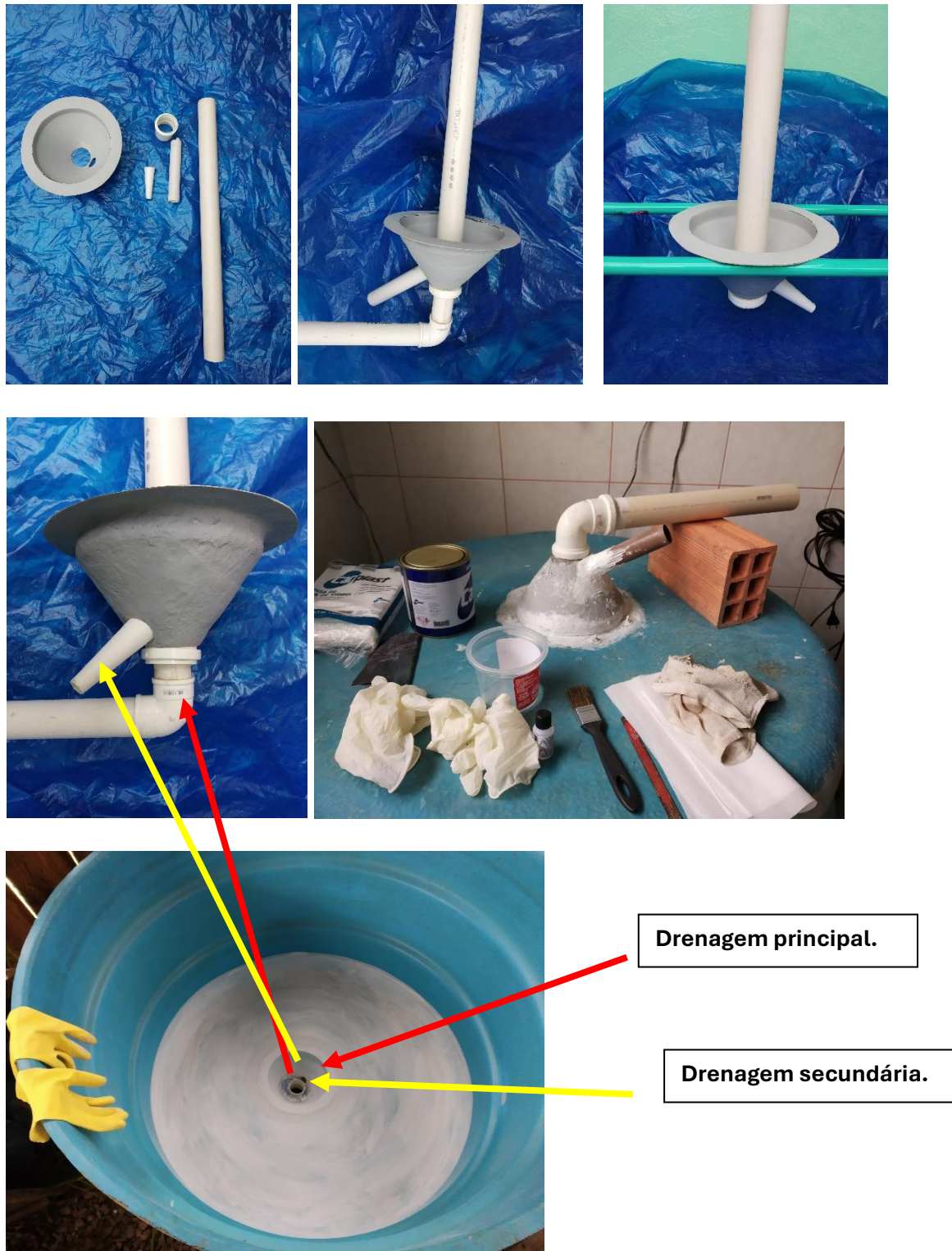
Figura 2- Processo sequencial da montagem das peças em fibra de vidro responsáveis pela captura das fezes sedimentam na caixa de cultivo.
