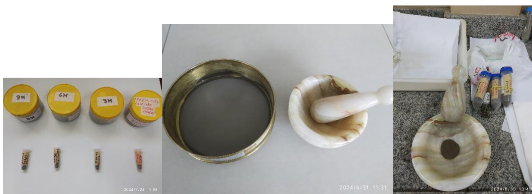
Figura 9. Processo de moagem e peneiramento de amostras de lodo procedentes de juvenis de truta Arco íris alimentados com diferentes dietas fermentadas.
