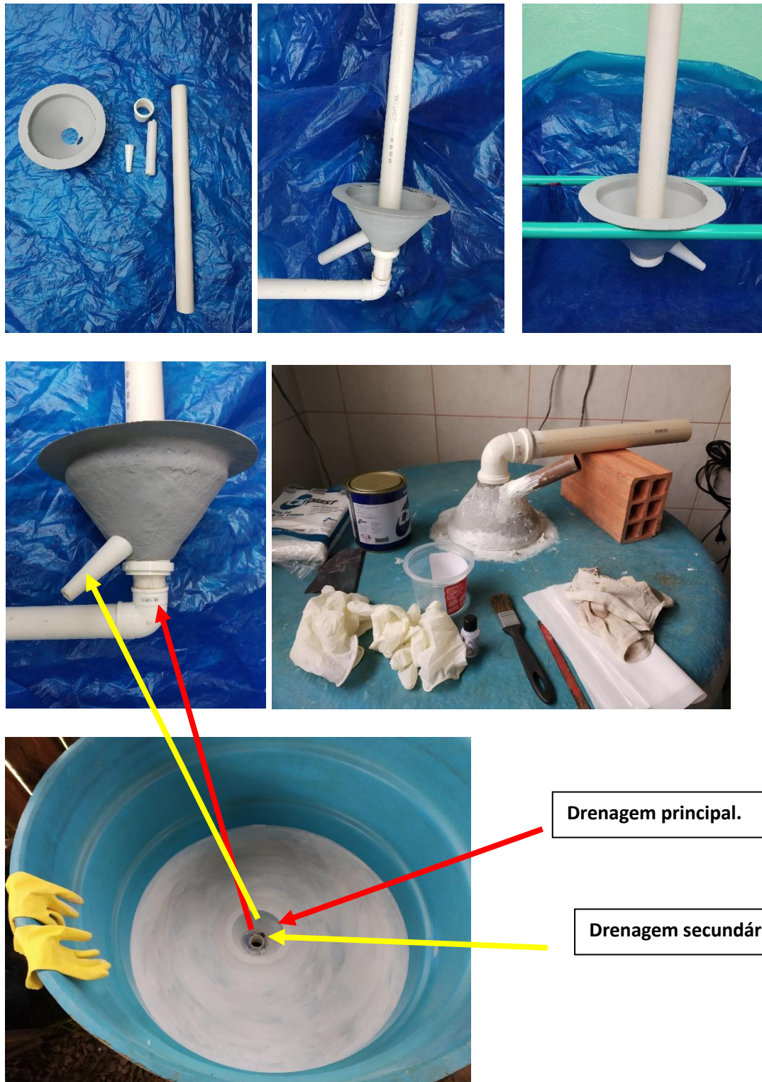
Figura 2- Processo sequencial da montagem das peças em fibra de vidro responsáveis pela captura das fezes sedimentam na caixa de cultivo.
