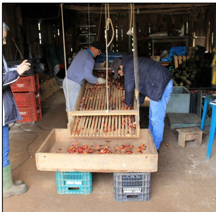
Figura 9 – Máquina de separar os pinhões das falhas de maneira semiautomática
