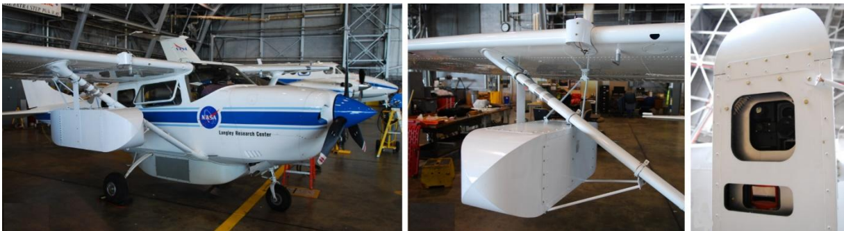
Figura 9 – Cessna 206 com G-LiHT
