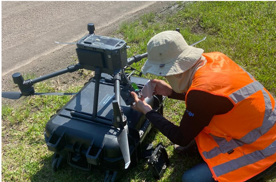
Figura 33 - UAV LIDAR sendo preparado para o voo
