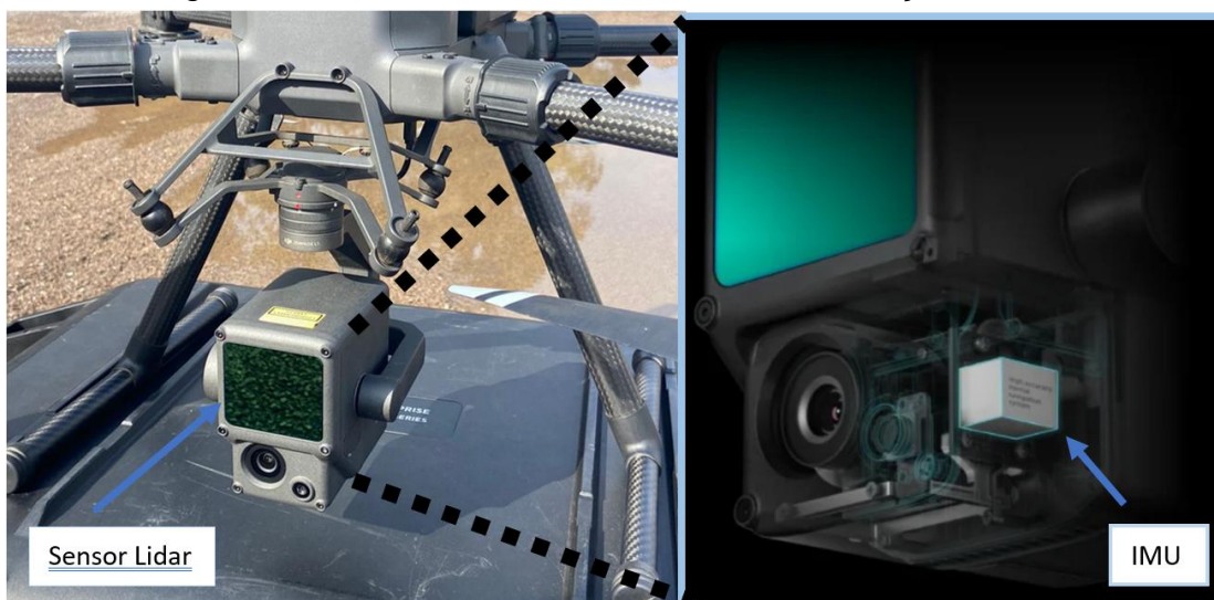
Figura 12 – Sensor LiDAR e detalhe da localização do IMU
