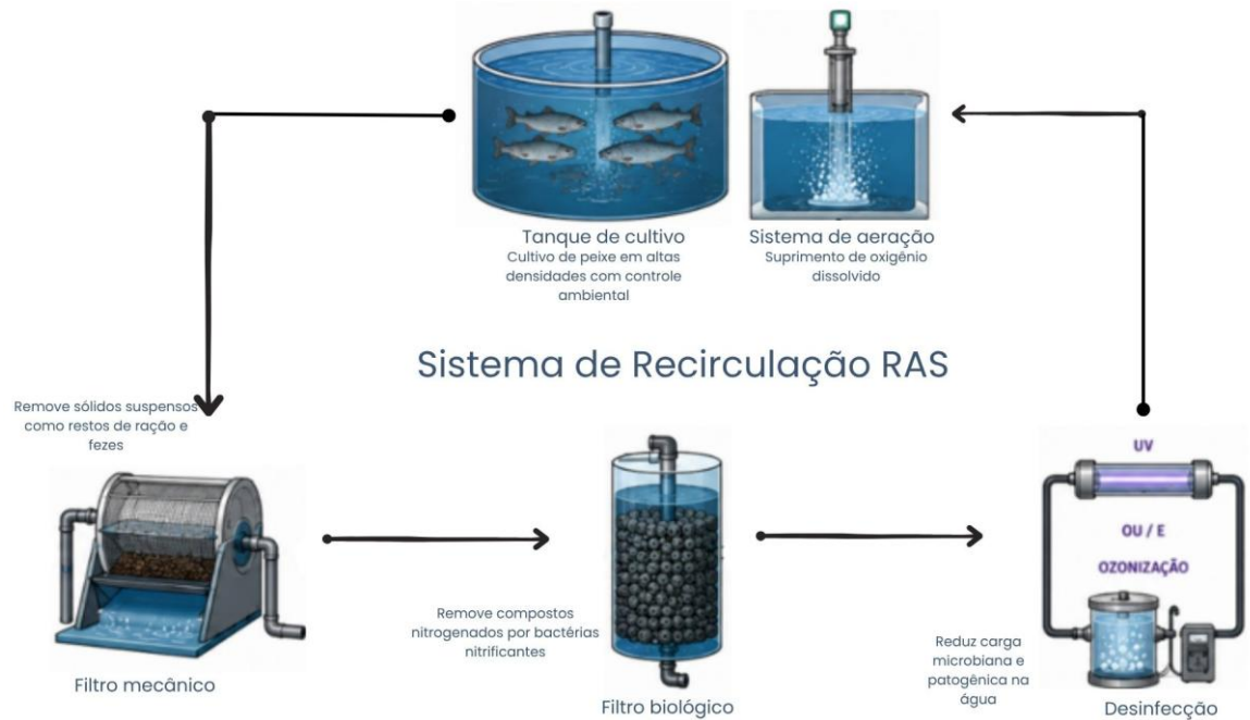
Figura 3. Esquema com etapas do sistema RAS
