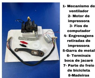
Figura 6 - Material necessário para a construção do minigerador
