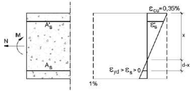
**f) Domínio 4a (flexão composta com armaduras comprimidas):**
