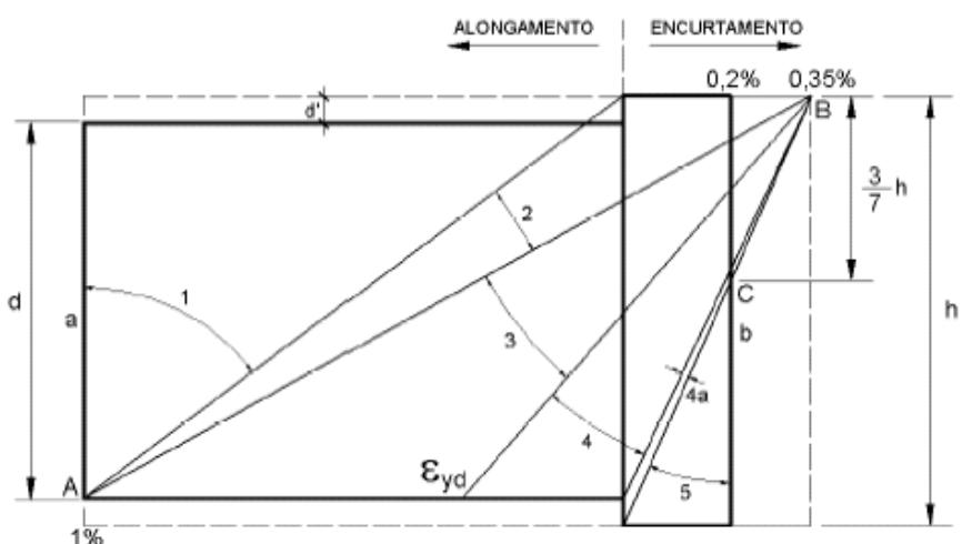
Com base nesta figura, faça uma explanação sobre os diversos domínios, identificando e justificando o melhor domínio para o dimensionamento de vigas sujeitas à flexão simples.
