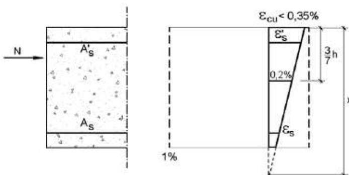
**h) reta “b”** - esta reta define uma deformação uniforme de compressão, onde o encurtamento atinge 0,2%, e a profundidade da linha neutra tende ao infinito.
