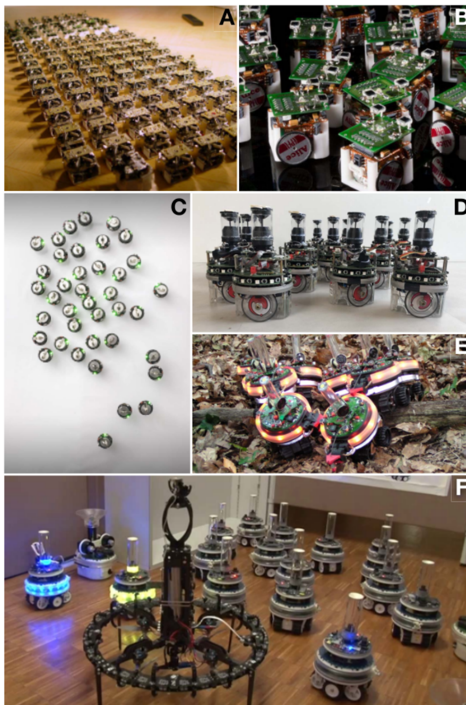
Figura 1 – Principais robôs utilizados em SR. (a) Jasmine; (b) Alice; (c) Kilobots; (d) e-pucks; (e) Swarm-bots; e (f) Swarmanoid.
