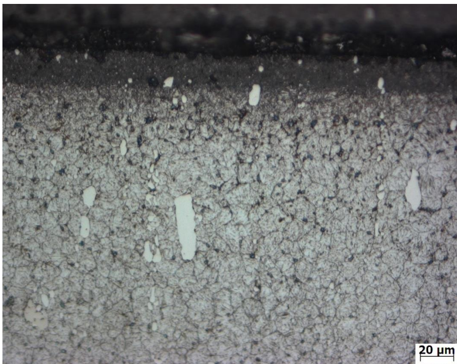
Figura 24 c– Microestrutura da camada nitretada na amostra do grupo 4
