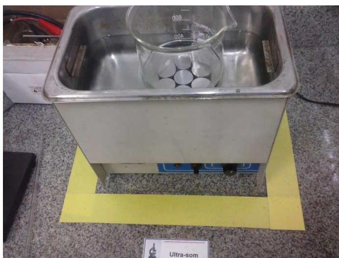
Figura 15– Limpeza das amostras em equipamento de ultrassom com álcool etílico a 96%.
