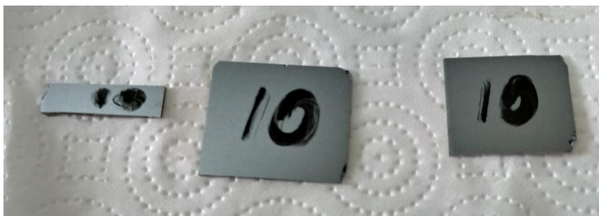
Figura 17 – Fotografia da parte traseira não polida das lâminas de Si clivadas e utilizadas como substrato.
