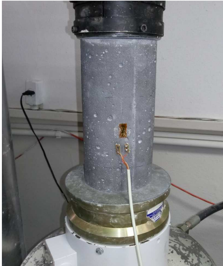
Figura 20 - Corpo de prova com strain gauge instalado e pronto para ensaio.
