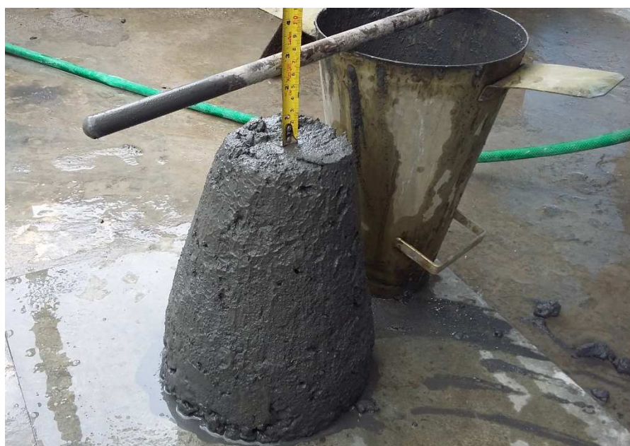
Figura 13 - Ensaio de consistência (slump test) da mistura teste do traço 3.
