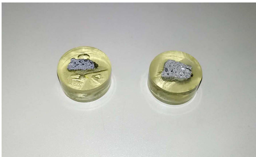
Figura 24 - Amostras embutidas em resina epóxi e polidas.
