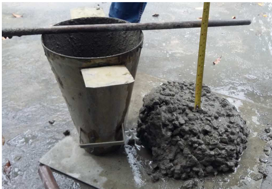
Figura 14 - Ensaio de consistência (slump test) da mistura teste do traço 7.
