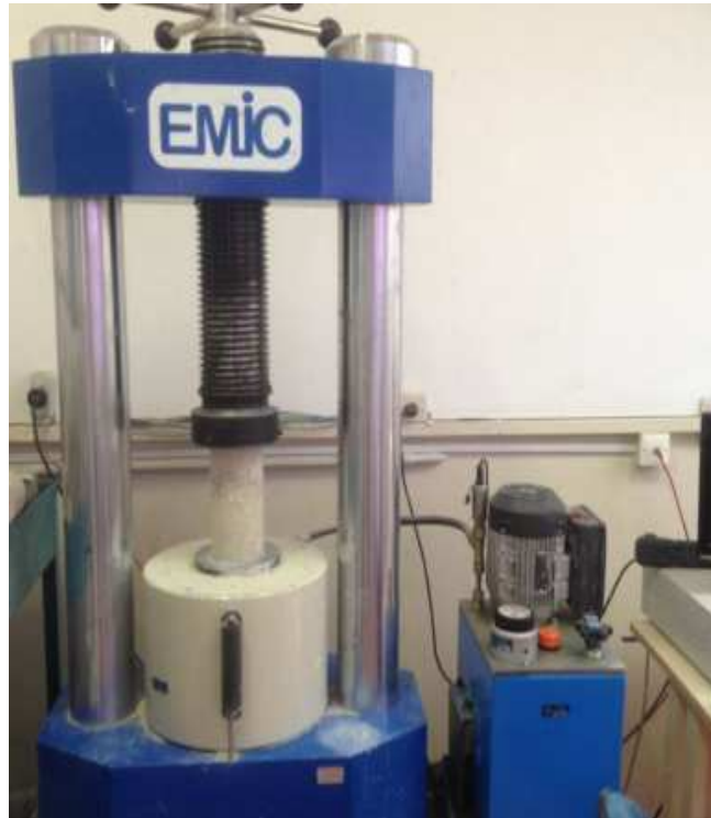
Figura 19 - Prensa EMIC utilizada nos rompimentos dos corpos de prova.
