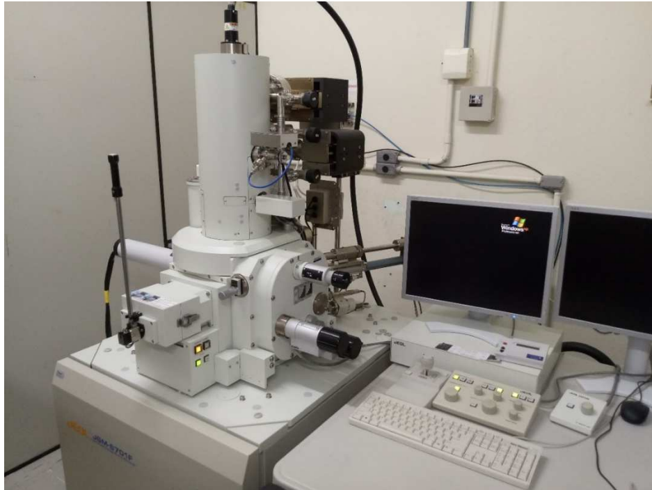
Figura 26 - Microscópio eletrônico de varredura utilizado no ensaio.
