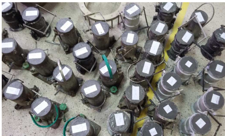
Figura 15 - Moldagem dos corpos de prova.
