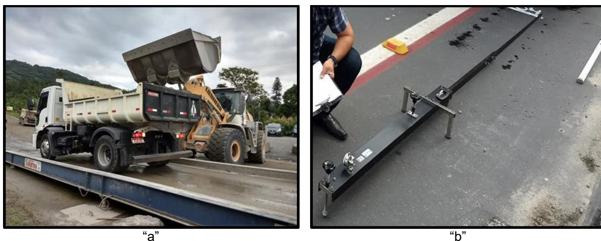
Figura 16 – Calibração da carga de reação e Viga Benkelman utilizada
