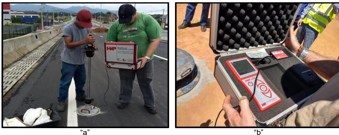
Figura 18 – Ensaio de LFWD no segmento 01 (Av. Santos Dumont)
