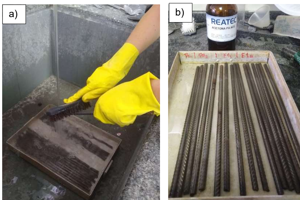
Figura 15 - Lavagem com água e escovação das barras de aço (a) e em seguida, imersão em acetona para secagem rápida (b)
