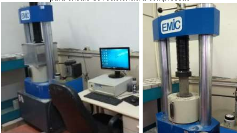
Figura 24 - Rompimento dos corpos de prova em prensa hidráulica automatizada para ensaio de resistência à compressão
