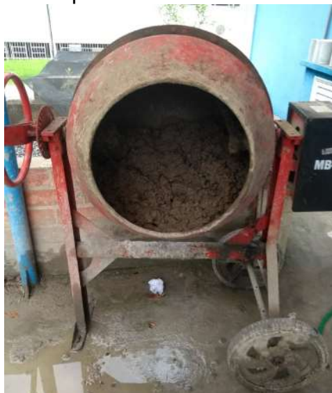
Figura 20 - Aspecto visual do concreto elaborado
