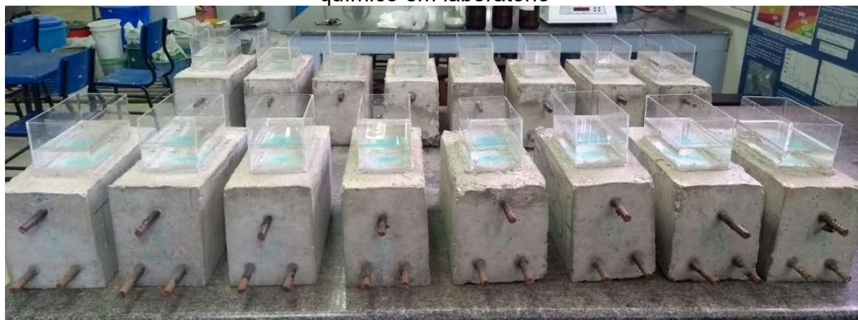
Figura 30 – Corpos de prova de concreto armado submetidos à ciclos de ataque químico em laboratório
