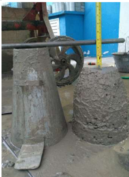
Figura 23 - Ensaio de abatimento de tronco cone
