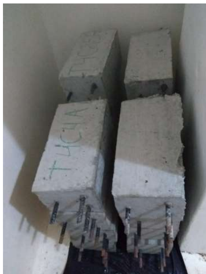
Figura 22 - Armazenamento dos corpos de prova de concreto armado em câmara úmida
