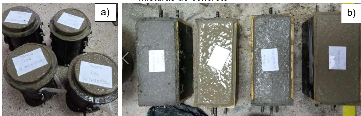
Figura 32 - Moldagem dos corpos de prova cilíndricos (a) e prismáticos (b) das misturas de concreto
