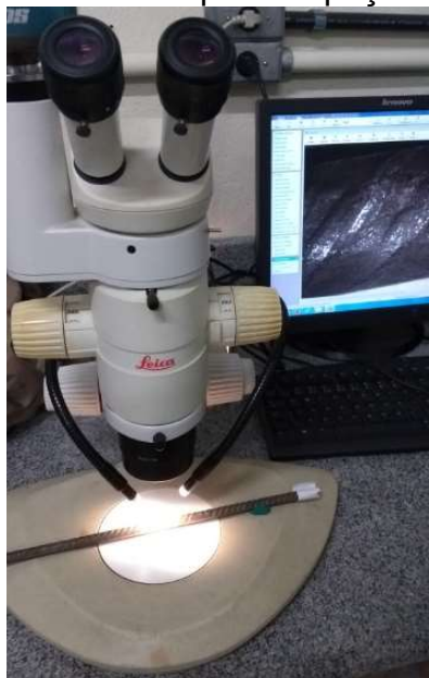
Figura 31 - Microscópio óptico utilizado para inspeção dos corpos de prova de aço
