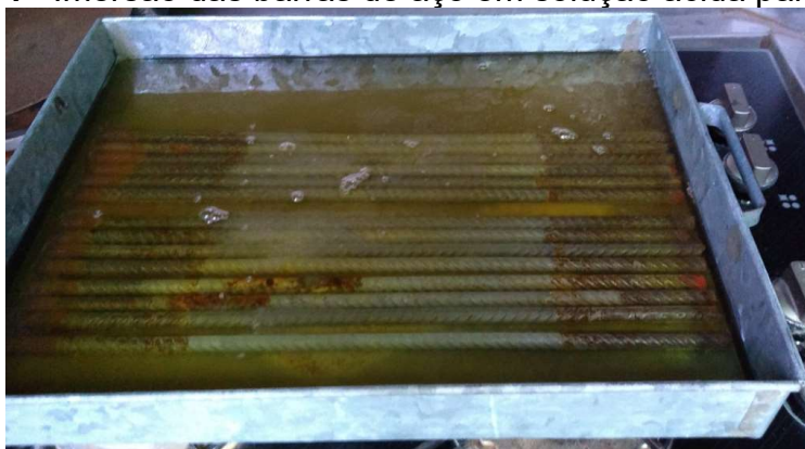
Figura 14 - Imersão das barras de aço em solução ácida para limpeza
