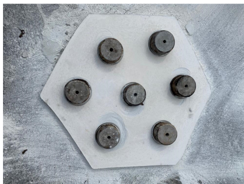
Figura 30 - Ensaio de resistência de aderência à tração
