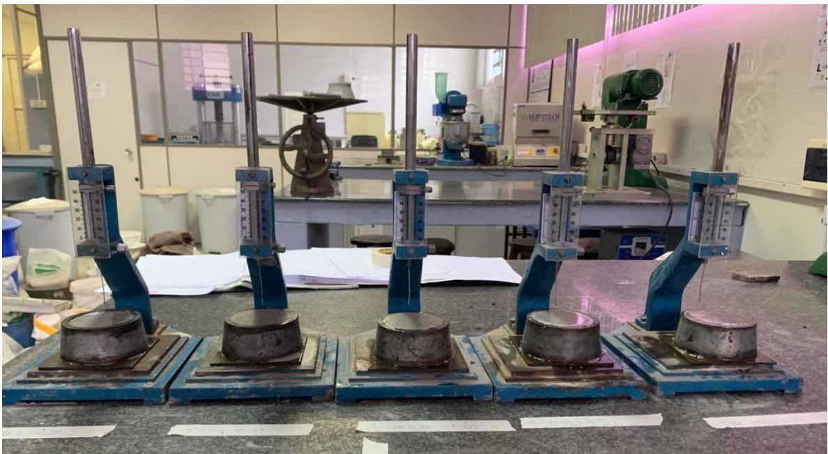
Figura 37 - Ensaio de Tempo de Pega com Aparato de Vicat
