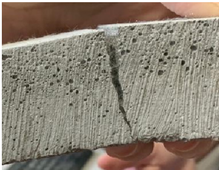
Figura 39 - Fibras no corpo de prova de argamassa
