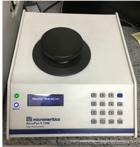
Figura 20 - Equipamento de picnometria de gás hélio
