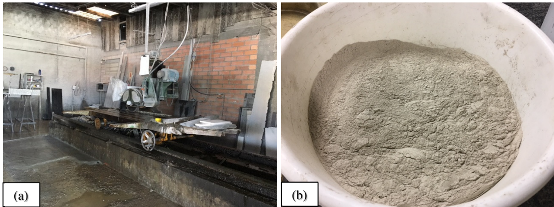
Figura 17 - Disco de corte de empresa beneficiadora (a); RCMG seco em estufa e peneirado (b).
