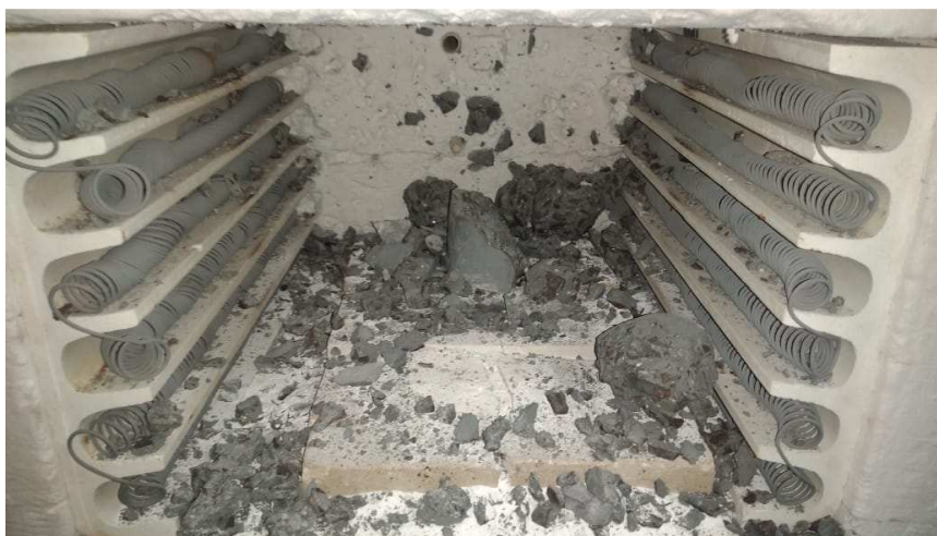
Figura 44 - Explosão da mistura CAD em 400°C.
