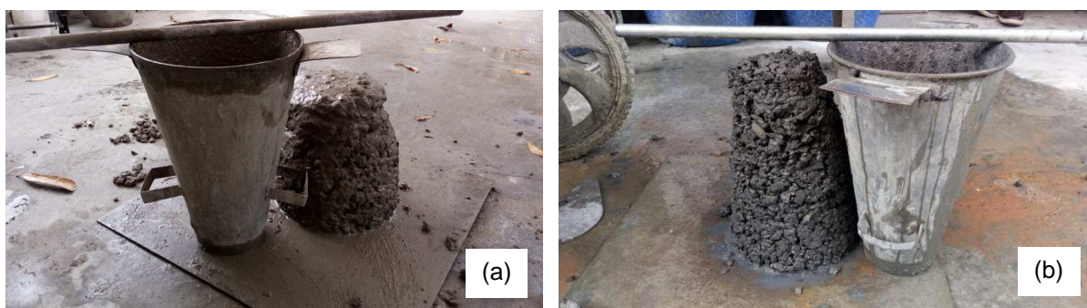
Figura 21 - Ensaio de abatimento do tronco de cone. (a) CC; (b) CAD.
