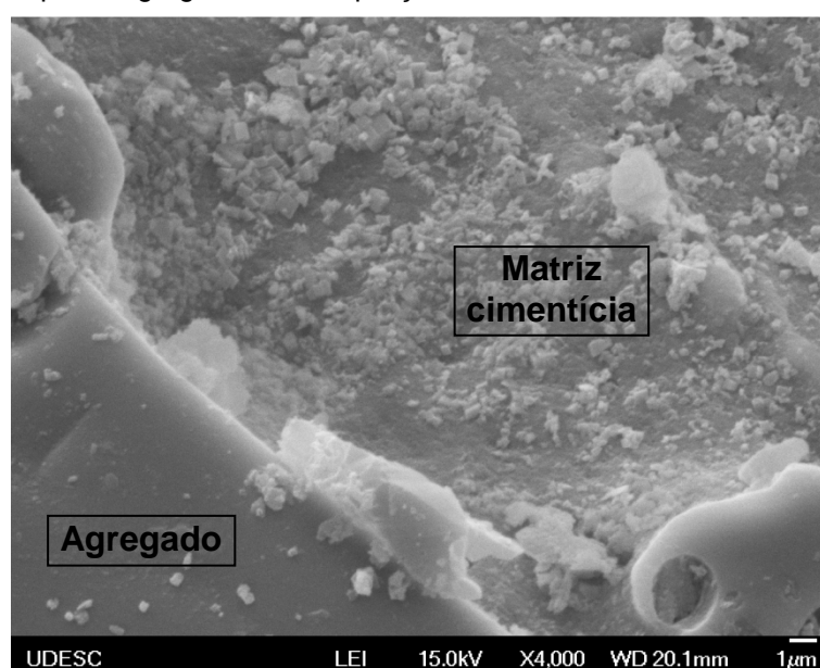
Figura 39 - Interface pasta-agregado com ampliação de 4000 vezes.
