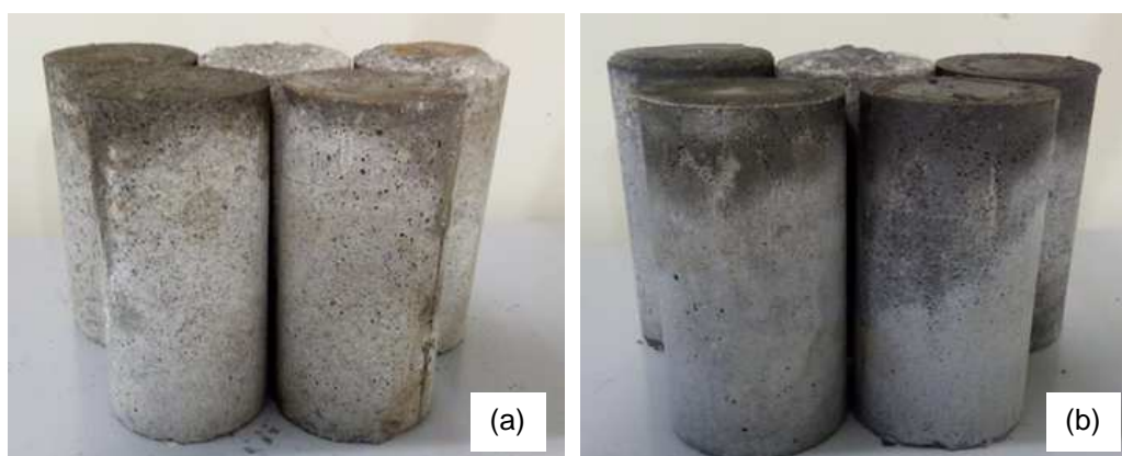
Figura 17 - Corpos de prova do ensaio de determinação do índice de desempenho com cimento Portland. (a) argamassa de referência; (b) argamassa com 25% de substituição de sílica ativa em suspensão.
