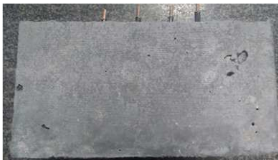
Figura 36 - Concreto de alto desempenho após ataque por sulfato.
