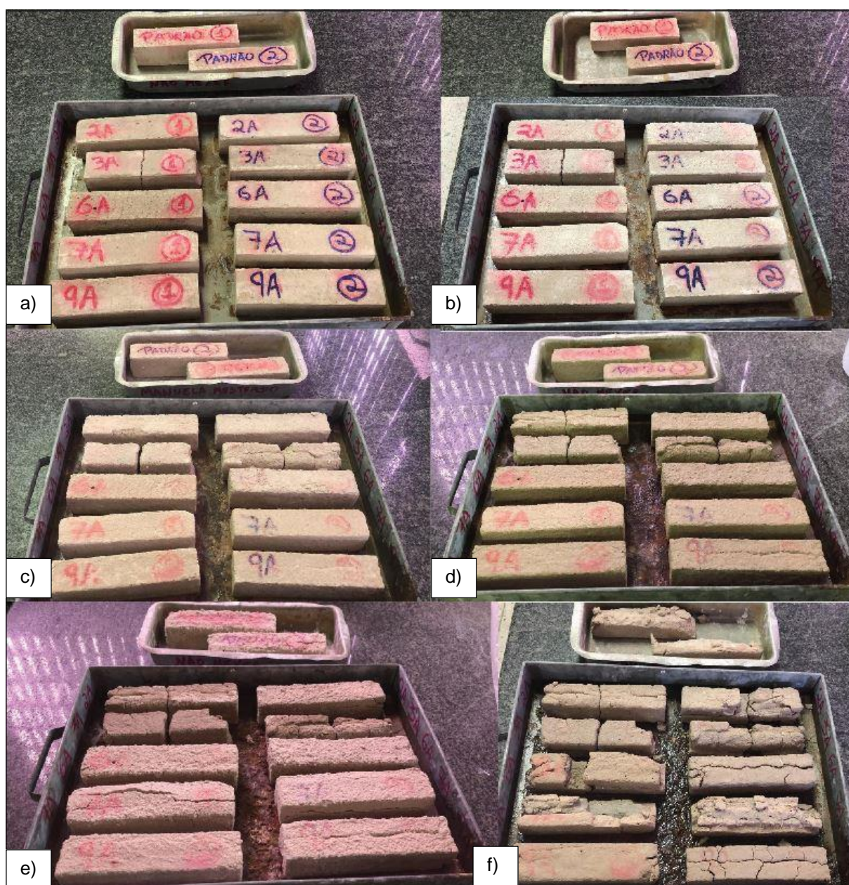
Figura 63 - Processo de deterioração das argamassas no ataque de sulfato: (a) 18/03; (b) 27/03; (c) 15/04; (d) 24/04; (e) 26/04; (f) 27/04.
