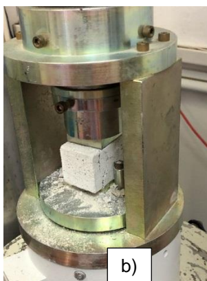
Figura 38 - Ensaio resistência à compressão: corpo de prova rompido
