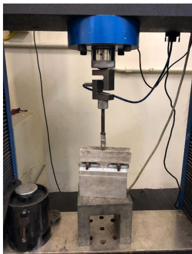
Figura 39 - Ensaio resistência à tração na flexão: corpo de prova rompido
