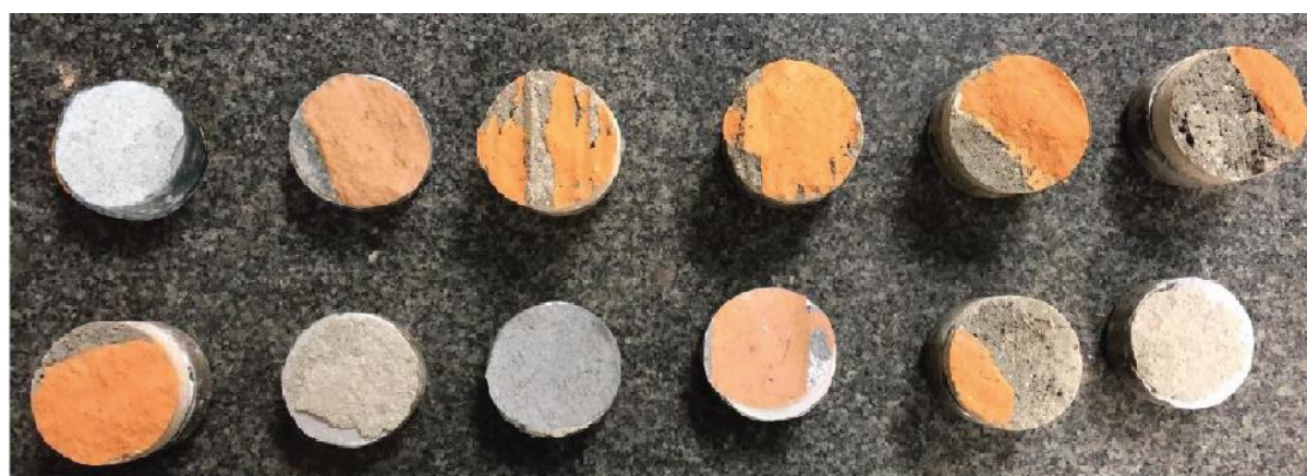
Figura 74 - Ruptura dos corpos de prova da argamassa R690T50S
