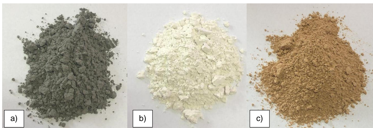
Figura 28 - Precursores, (a) cinza volante, (b) escória granulada de alto forno, (c) metacaulim
