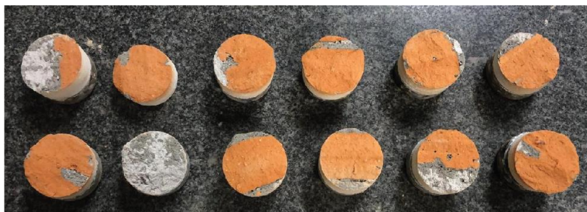
Figura 73 – Ruptura dos corpos de prova da argamassa de referência
