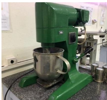
Figura 34 - Preparação da argamassa - misturador mecânico
