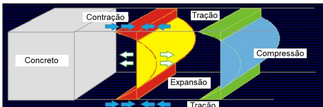
Figura 4 – Restrições Internas Pelo Efeito Térmico Causado pela Hidratação do Cimento em Concreto Massa
