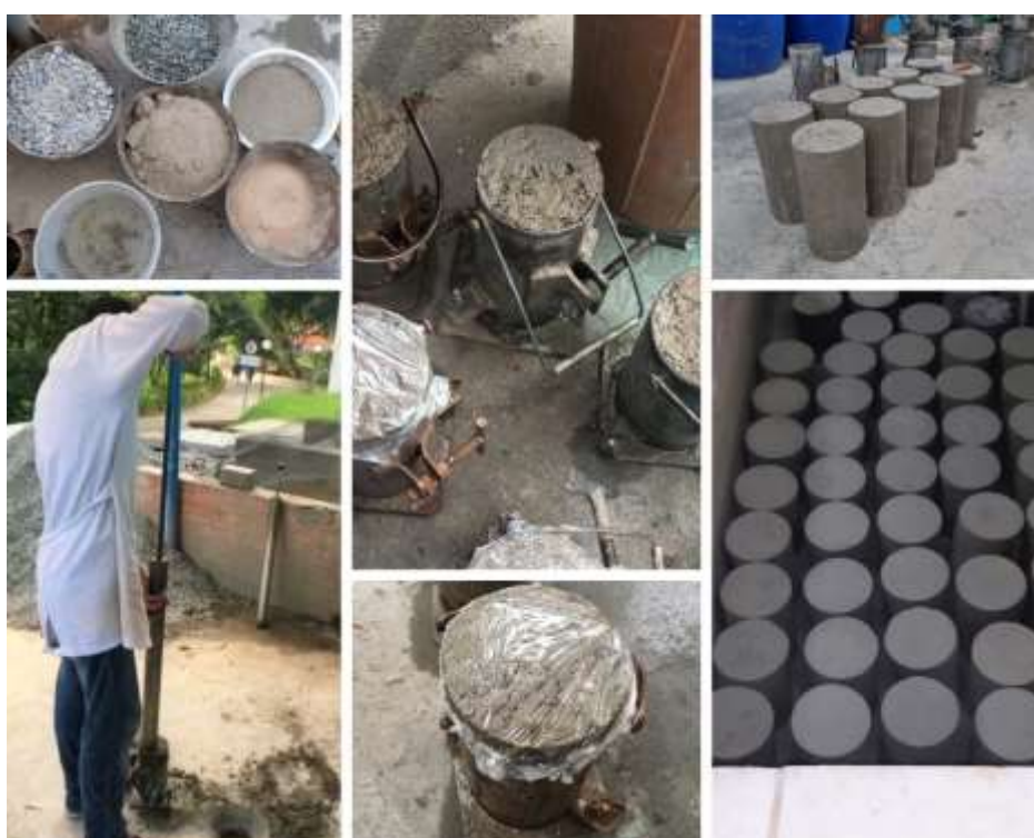
Figura 18 - Registro de etapas da moldagem de CP cilíndricos
