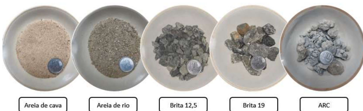
Figura 9 - Amostras dos agregados utilizados na pesquisa
