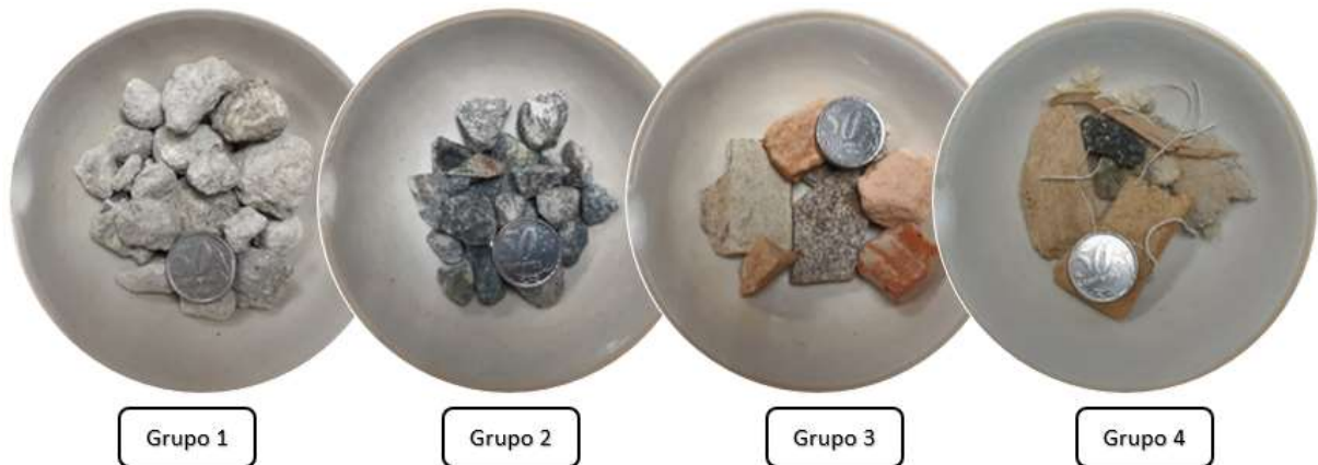
Figura 8 - Amostras dos grupos requeridos pela NBR 15116
