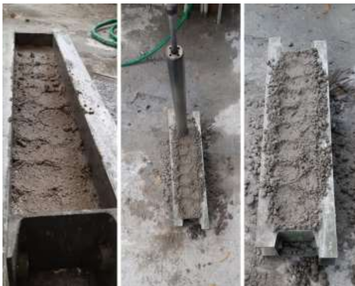
Figura 19 - Registro da moldagem de CP prismáticos
