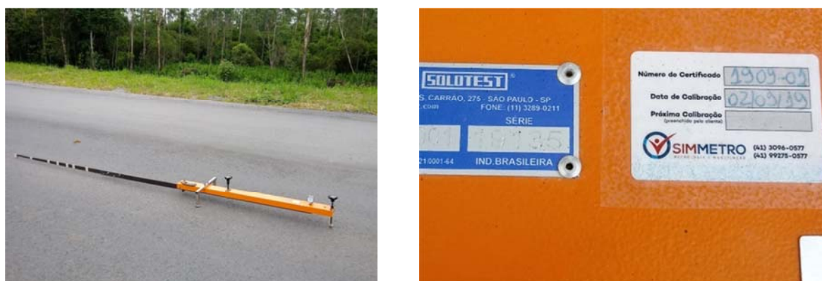
Figura 34 - Viga Benkelman empregada em medições na Estrada Rio do Morro
