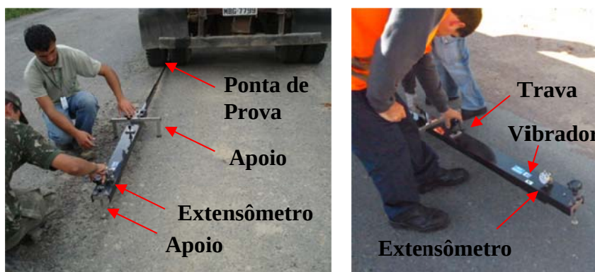
Figura 12 - Viga Benkelman posicionada para a medição
