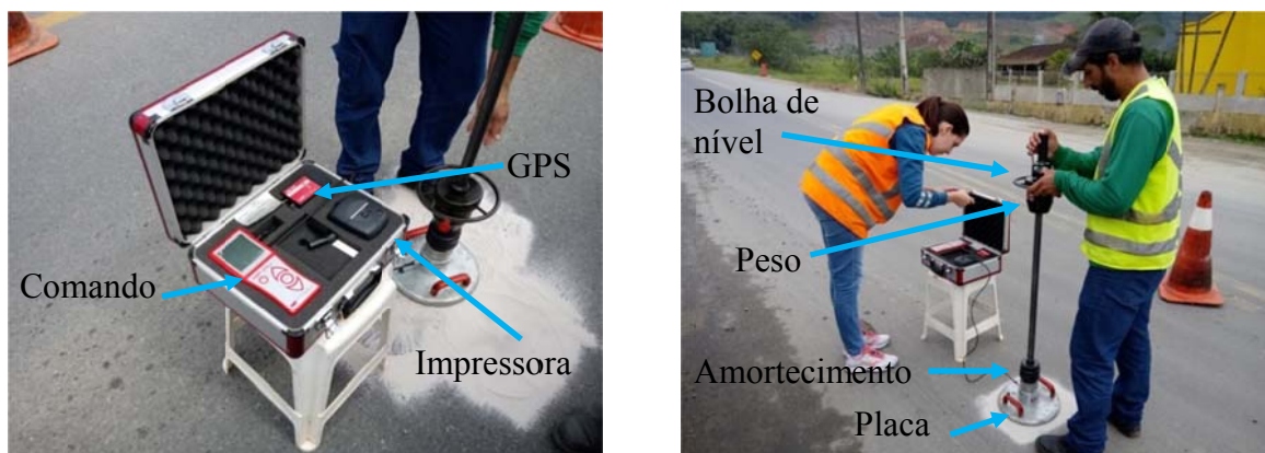
Figura 32 - Equipamento LWD durante as medições na Estrada Rio do Morro
