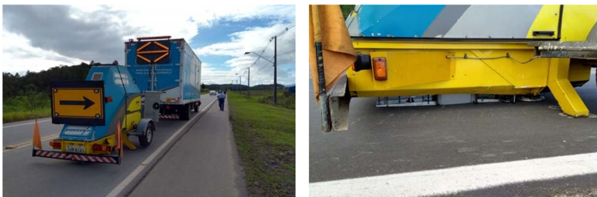
Figura 31 - Equipamento FWD durante as medições na Estrada Rio do Morro
