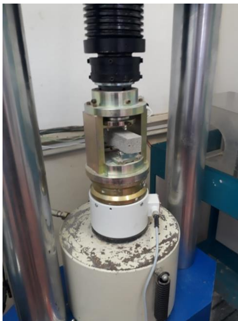
Figura 30 - Corpo de prova na prensa hidráulica
