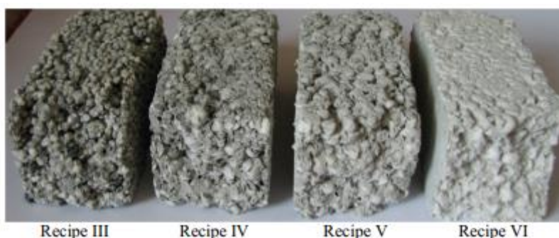
Figura 16 - Argamassas contendo EPS
