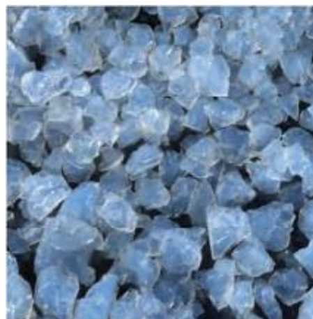
Figura 26 - Grânulos de sílica aerogel
