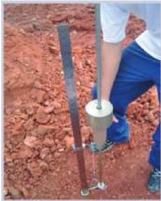
Figura 11 - Exemplo de DCP de avaliação estrutural expedita de subleitos e camadas de solo
