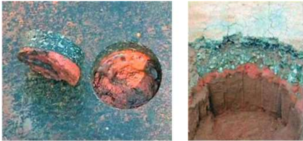
Figura 10 - Exemplos de extração de um corpo de prova do pavimento asfáltico
