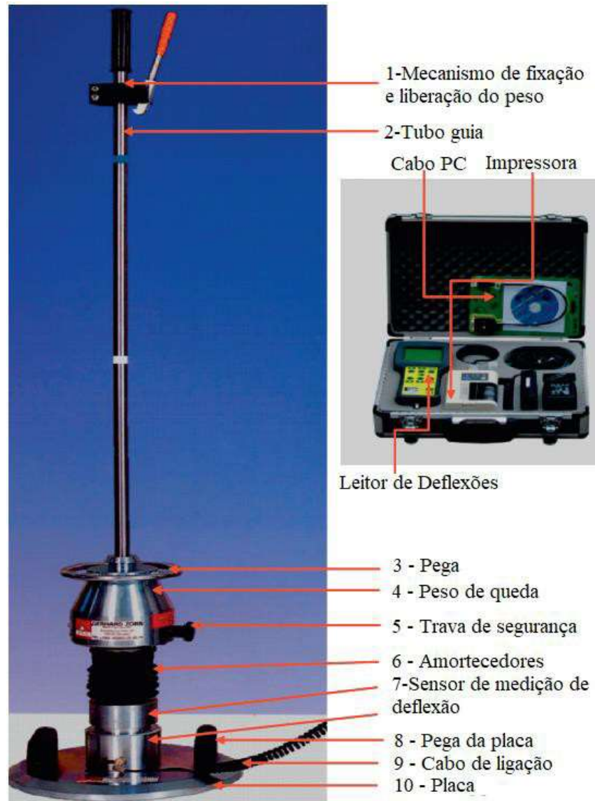
Figura 12 - Constituição de um tipo de equipamento LWD
