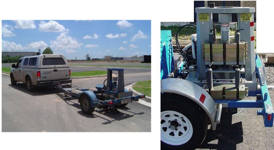
Figura 14 - Equipamento FWD em seu trailer sendo rebocado por um veículo de apoio e detalhe da parte do sistema de pesos para aplicação das cargas por impacto
